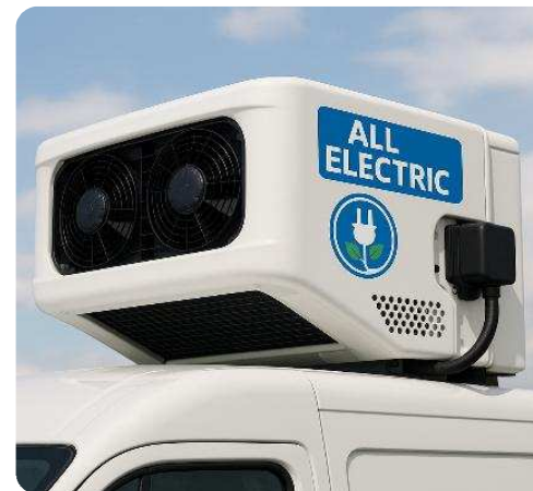
Strom für elektrische Kühlaggregate
