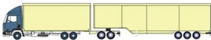
Abbildung 4: Lang-Lkw Typ 3 - Lastkraftwagen mit Untersetzachse und Sattelanhänger (BMDV - Lang-Lkw, 2022)
